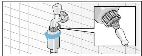
6. Чистка фильтра на задней стенке прибора:
