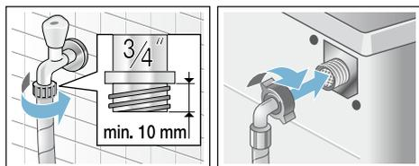
Осторожно открыть водопроводный кран и проверить герметичность в местах соединений.
