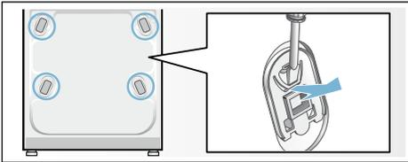
2. Вставить на место все 4 втулки. Зафиксировать сетевой кабель в креплениях. Вставить винты и затянуть их.
