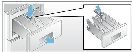
3. Ванночку для подачи моющих средств и вставку промыть в воде с помощью щетки и вытереть их насухо. Также выполнить чистку корпуса внутри.
