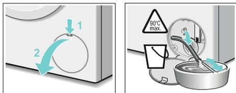
5. Снять закрывающую пробку, слить стиральный раствор в соответствующую емкость. Придавить закрывающую пробку и вставить сливной шланг в держатель.
