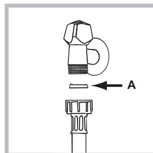
1. Вставьте прокладку A в конец заливного шланга и наверните его на вывод водопровода холодной воды с резьбовым отверстием 3/4 дюйма (см. рис.).
