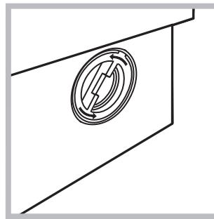
2. выверните крышку фильтра, вращая ее против часовой стрелки (см. рис.): из насоса может выплыть немнога воды — это нормальное явление;
