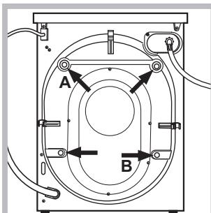
3. Снимите 4 винта, предохраняющие машину в процессе перевозки, и резиновые пробки с соответствующими распорными шайбами, расположенные в задней части стиральной машины (см. рис.).
