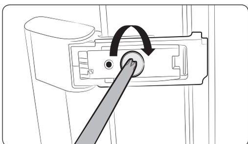
6. Зафиксируйте ручку с помощью крестообразной отвертки.
