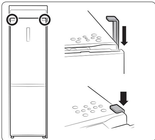
6. Для заполнения зазоров вставьте “Г”-образные детали с каждой стороны между шкафом и холодильником, как показано на рисунке.
