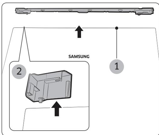
1. Снимите крышку отсека для проводов ( 1 ) и заглушку формы "L" ( 2 ).
