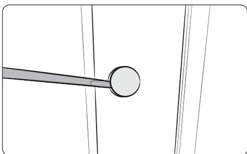
5. Снимите две заглушки (вверху и внизу) на ручке с помощью плоской отвертки.
