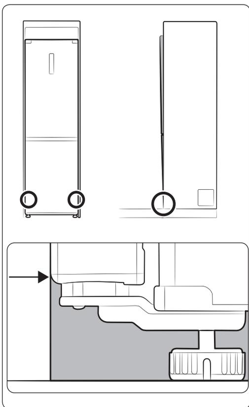
4. Задвиньте изделие в шкаф таким образом, чтобы нижняя часть изделия не выступала из нижней части шкафа.
