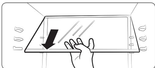
1. Чтобы передвинуть полку, возьмите ее двумя руками и потяните так, чтобы она высвободилась из задних креплений. Затем потяните ее к себе до середины.
