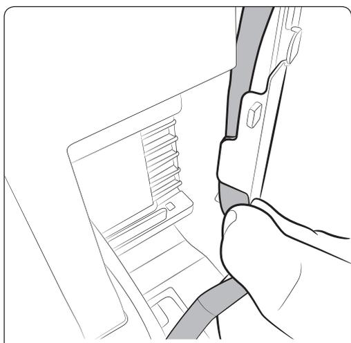
18. Установите крышку отсека для кабелей сверху дверцы холодильной камеры и нажмите на нее для полной фиксации. Проверьте положение кабелей, которые должны располагаться на обратной стороне крышки для кабелей.
