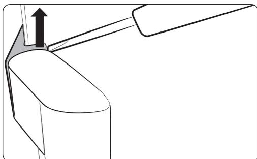
1. Поднимите внутренний крючок плоской отверткой
