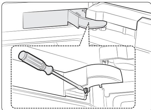
2. Снимите крышку петли, чтобы нажать на крючок, как показано на рисунках ниже.
