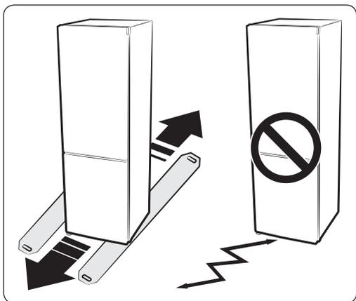
Холодильник необходимо установить на ровной поверхности из твердого материала, который имеет ту же толщину, что и остальная часть покрытия. Поверхность должна быть достаточно прочной, чтобы выдержать вес полностью загруженного холодильника. Чтобы не повредить напольное покрытие, вырежьте и положите под холодильник большой лист упаковочного картона.
