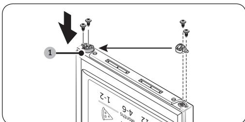
1. С двери морозильной камеры, снимите **автоматический рычажный замыкатель (1)**, ослабив винты на замыкателе и винты на противоположной стороне.
