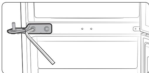
8. Установите на место среднюю петлю с помощью 5-мм торцевого ключа. Прежде всего, установите дверцу морозильной камеры и среднюю петлю. После чего установите нижнюю петлю, а также дверцу холодильной камеры и верхнюю петлю.
