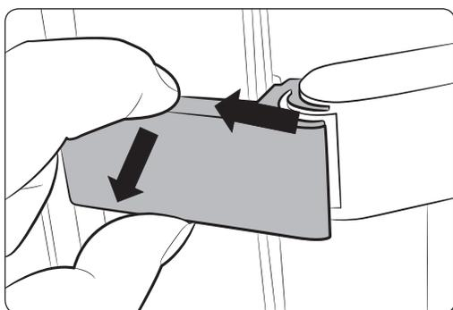
2. Направленным вверх усилием снимите крышку.
