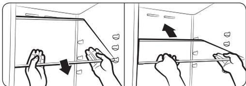
4. При подтягивании передней части полки вставьте ее заднюю часть в задние крепления.
