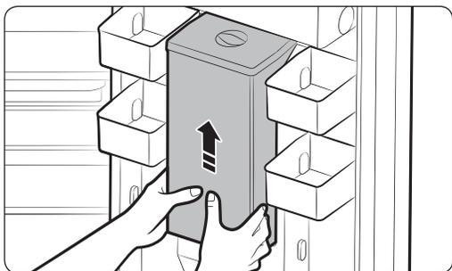
Приподнимите вверх фиксатор емкостей, крепко удерживая обеими руками резервуар для воды, а затем поднимите его и потяните на себя, чтобы извлечь из холодильника.
