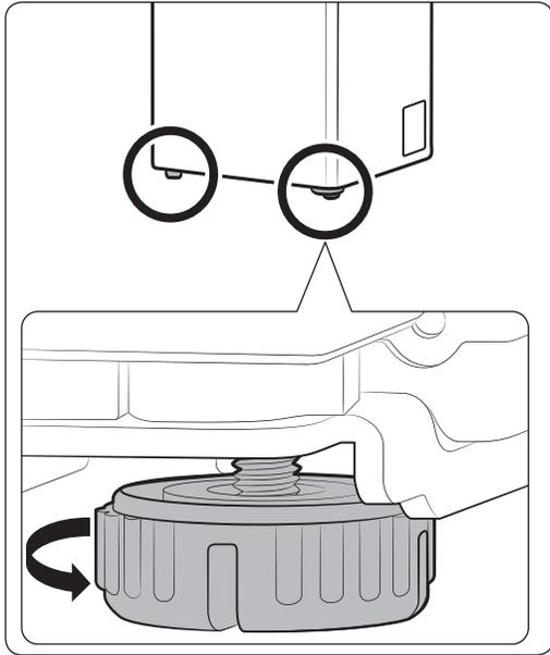
1. Поверните опору по часовой стрелке, чтобы выдвинуть ее на 9 мм (8 оборотов).
