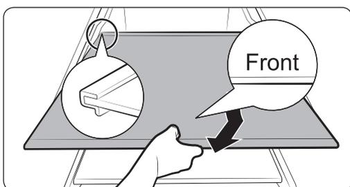
Чтобы освободить больше места в холодильнике, извлеките верхний и средний ящики холодильной камеры и вставьте полку морозильной камеры вместо нижней части ящика. Это не повлияет на температурные и механические характеристики изделия.
