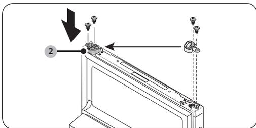
1. С двери холодильника, снимите **автоматический рычажный замыкатель (2)**, ослабив винты на замыкателе и винты на противоположной стороне.
