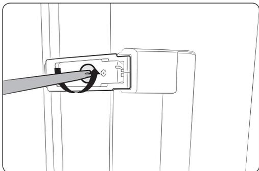
4. Ослабьте два винта (верхний и нижний) с помощью крестообразной отвертки, чтобы снять ручку.
