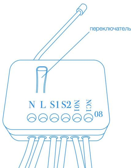
**Рис. 5 Переключатель режима добавления/удаления устройства**
