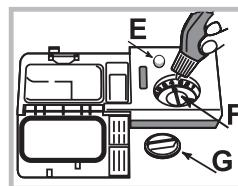
1. Otworzyć pojemnik, przekręcając korek „G” w kierunku przeciwnym do ruchu wskazówek zegara.
