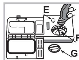
1. Otvorite spremnik okretanjem čepa "G" suprotno od smjera kazaljke na satu.
