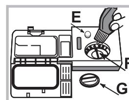
1. Откройте дозатор, повернув крышку "G" против часовой стрелки.
