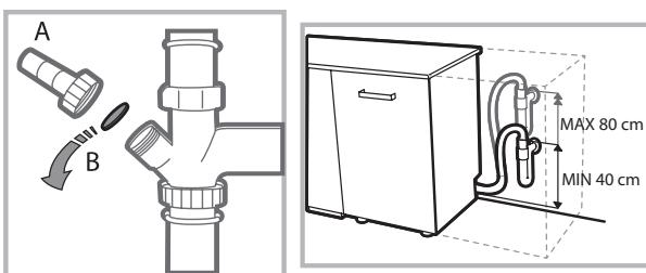
Prije spajanja cijevi za odvod vode na sifon sudopera, izvadite plastični čep (B).
