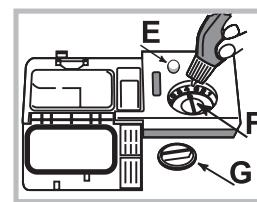
1. Aprire il serbatoio ruotando il tappo "G" in senso antiorario.
