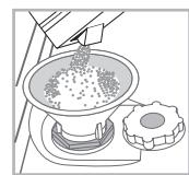
1. Estrarre il cesto inferiore e svitare il tappo del serbatoio in senso antiorario.
