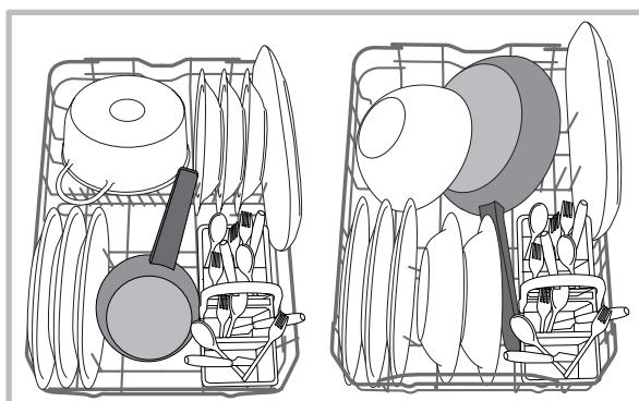
Рекомендуется разместить сильно грязную посуду в нижней корзине, так как в этой части струи воды более сильные и обеспечивают оптимальную мойку посуды.
