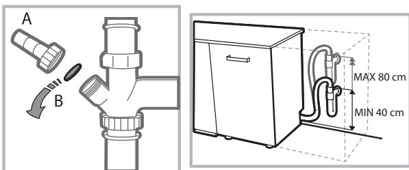
Перед подсоединением сливного шланга к сифону мойки снимите пластиковую пробку (B).
