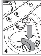
После чистки фильтров точно установите фильтрующий узел на свое место, что является важным для исправной работы посудомоечной машины.
