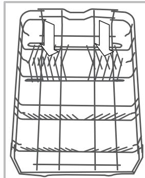
Некоторые модели посудомоечных машин оснащены наклонными отделениями\*, которые можно использовать также в вертикальном положении для размещения тарелок или в горизонтальном положении (наклонном) для более удобного размещения кастрюль и салатниц.
