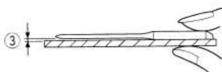
Чтобы проверить качество иглы, положите её плоской стороной на ровную поверхность (игольную пластину, стекло и т.д.). Зазор между иглой и плоской поверхностью должен быть одинаковым.
