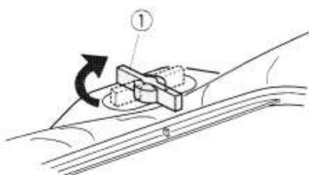
Поверните установочный винт по часовой стрелке.
