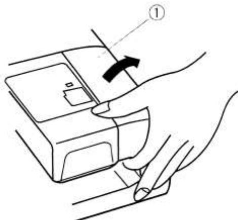
Снимите приставной столик при работе с дополнительными пяльцами С.
