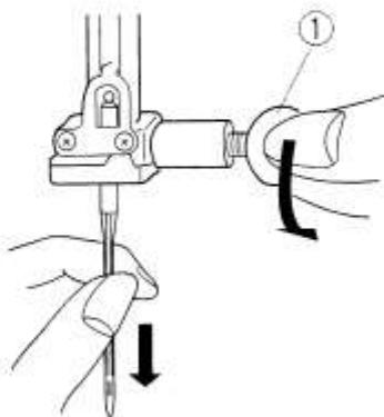
Отключите питание. Поверните маховое колесо, поднимите иглу и опустите прижимную лапку. Ослабьте винт игольного стержня, повернув его против часовой стрелки. Вытащите иглу из зажима.
