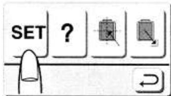
Нажмите на клавишу "Установки" (SET), чтобы открыть экран режима установок машины.
