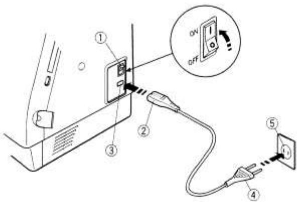
Отключите питание, вставьте разъём в гнездо машины.
