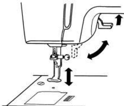
Рычаг подъёма прижимной лапки поднимает и опускает её.
