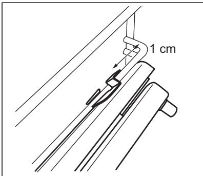
3. Поверните направляющую в надлежащее положение. Стопоры на концах телескопической направляющей должны быть обращены вверх.
