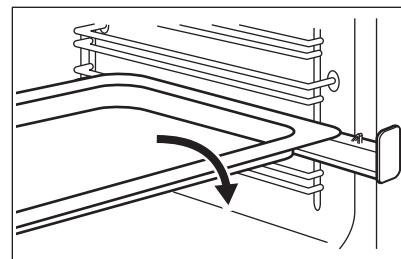
Одновременная установка решетки и противня для жарки:
