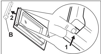
3. Чтобы снять дверную планку, потянните ее вперед.
