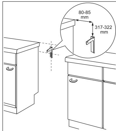
2. Отверстие для крепления находится слева на задней стороне прибора. Поднимите переднюю часть прибора и поместите его между кухонными шкафами. Если расстояние между кухонными шкафами больше, чем ширина прибора, следует установить его так, чтобы зазоры с обеих сторон были одинаковыми.
