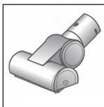
Одновременно чистит щёткой и всасывает пыль при чистке мягкой мебели, матрасов, автомобильных сидений и т. д. Особенно эффективна при удалении шерсти животных. Валик щётки приводится в движение потоком всасываемого пылесосом воздуха.
