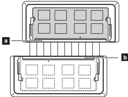
Для проверки правильности установки модуля DDR3 SDRAM выполните следующие действия.
