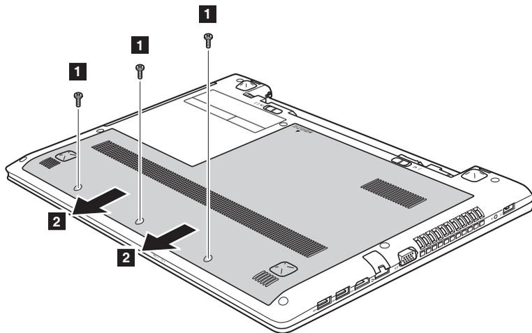
5 Открутите винты крепления каркаса 3.
